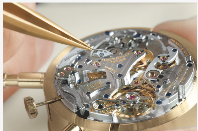
Dieses Uhrwerk ist fast fertig. Der Schalthebel wird montiert.
